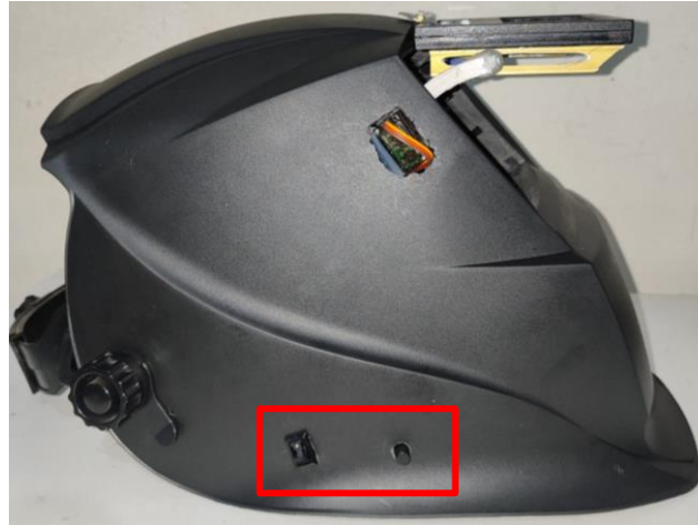
Figura 31: Colocación de switch y pulsador
