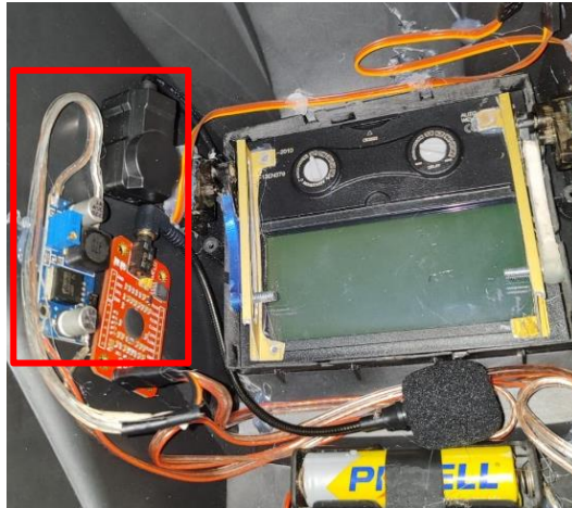
Figura 33: Colocación de regulador de voltaje
