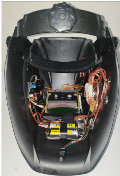
Figura 35: Distribución final de componentes en el casco
