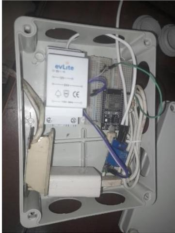
*Figura 16 Proceso de montaje de la caja con ESP32, transformador, tomacorriente y relé*
