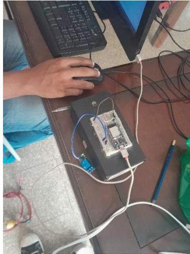
*Figura 14 Prueba de conexión del Esp32*
