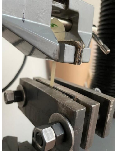
Esfuerzo axial producido en la biopelícula.
