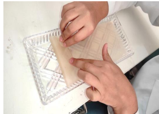
Desmoldado de la biopelícula.
