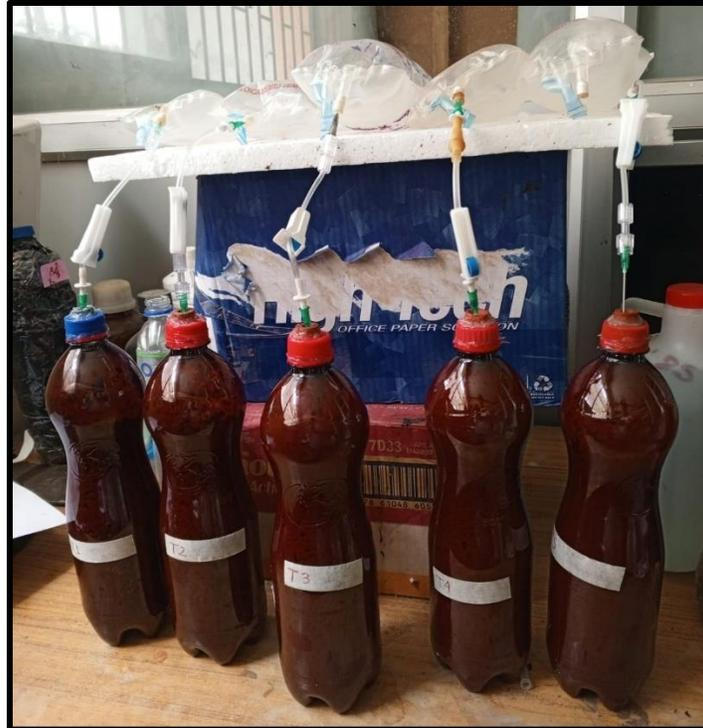
*Anexo H. Monitoreo del volumen del biogás con bolsas de propileno esterilizadas de 500 ml.*
