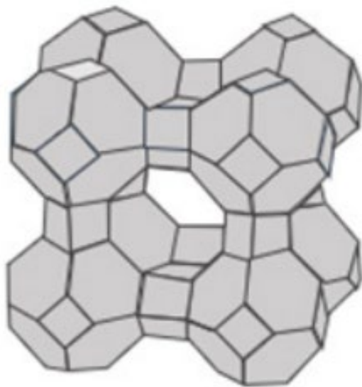
Figura 9. Estructura tridimensional de la zeolita
