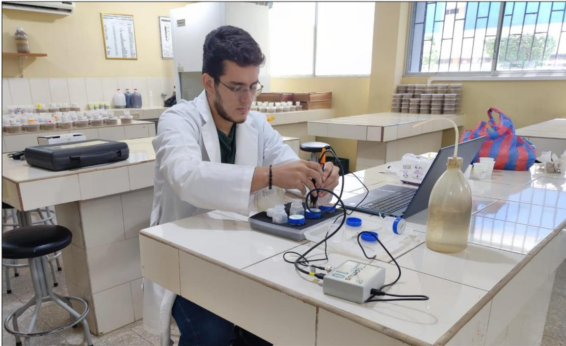
**Figura 6.** Calibración, acondicionamiento y determinación de nutrientes en laboratorio de la Facultad de Ciencias Agropecuarias con medidor multiparametro Imacimus 10.
