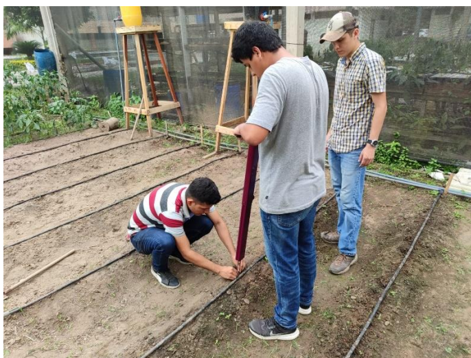
Figura 15. Uso de la sonda TDR, antes de la siembra.
