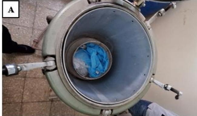
**Figura 14.** *Desinfección de materiales en autoclave a 121°C.*
