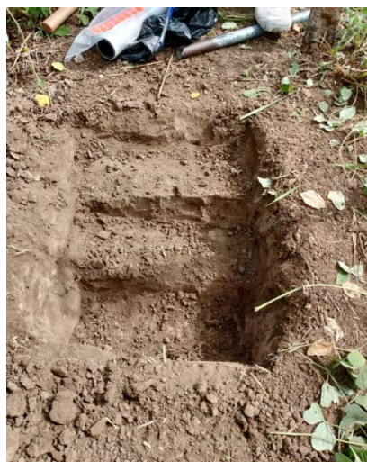
Figura 2: Calicata de 50 x 70 cm con estratos de 0-10,10-20 y 20-30 cm.
