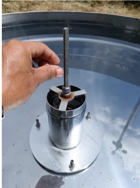
Figura 4: Tanque evaporímetro de la estación meteorológica de la granja Sta Inés.
