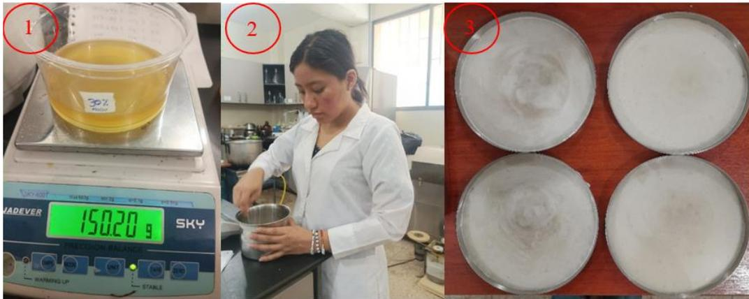
Nota. La imagen 1 corresponde a la parte de pesado de cada uno de los componentes de la solución, en la imagen 2 se muestra la mezcla de la solución y la imagen 3 presenta las muestras en las bandejas metálicas recién sacadas del congelador
