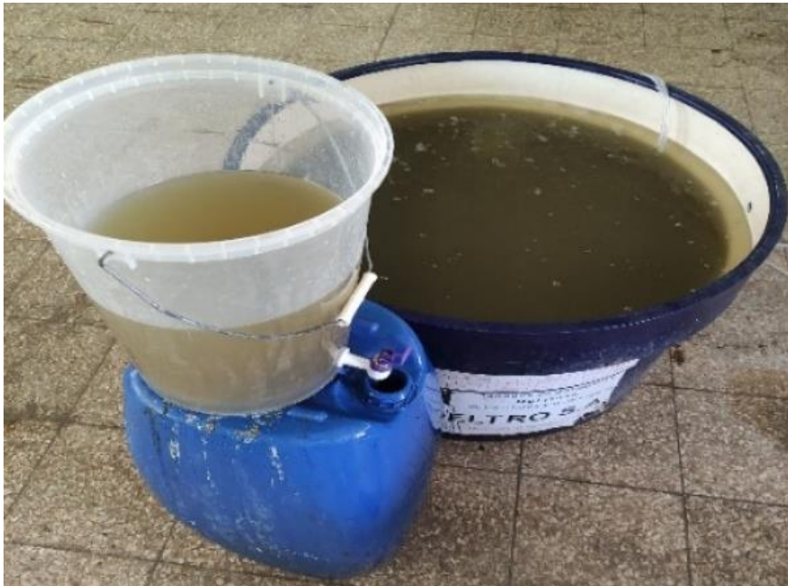
Anexo 7: Tanques usados como reservorio, aplicando aireación 24/7.
