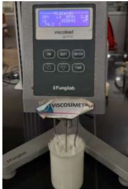
Figura 4 Medición de la viscosidad de la emulsión
