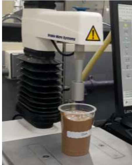
Figura 5 Montaje del texturómetro para medir la firmeza de las muestras
