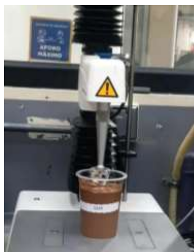
Figura 6 Montaje del texturómetro para medir la suavidad de las muestras
