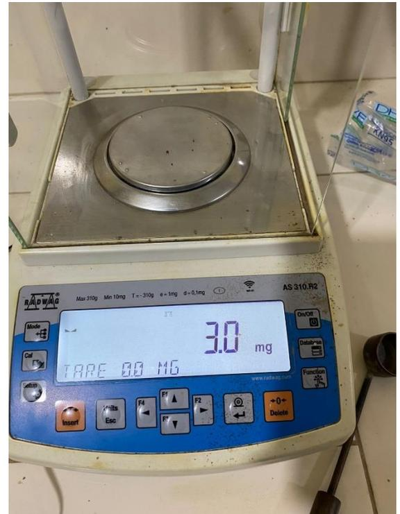
**Figura 21.** Pesaje de cloruro de cobalto utilizando la balanza analítica.
