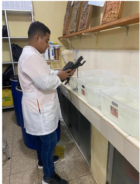
**Figura 18.** Medición de oxígeno disuelto en el agua dulce para la eliminación del mismo.
