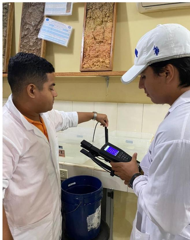
**Figura 17.** Medición de incremento de oxígeno al aplicar SPC.
