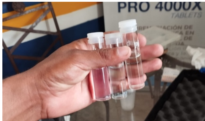
Figura 25. Tiempo de reacción tras aplicación de los reactivos a las muestras.
