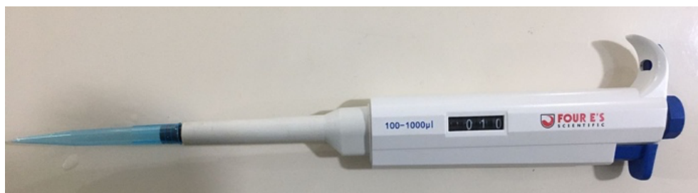
Figura 20. Toma de 10 µl con una micropipeta para conteo de fitoplancton.
