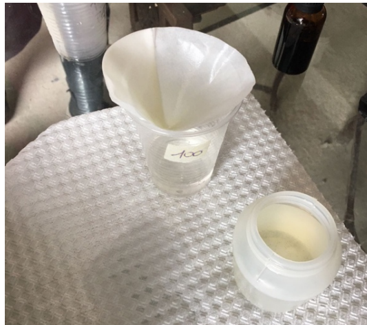
Figura 22. Proceso de filtrado del agua con la ayuda de papel filtro.
