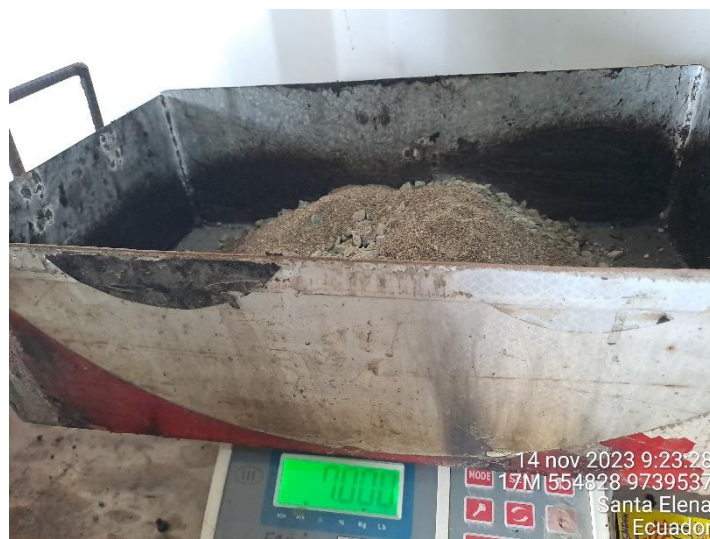
Ilustración 20 Mezcla de material Virgen y Reciclado, pesaje
