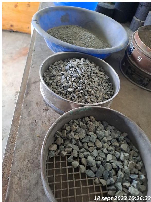
Ilustración 18 Ensayos de material virgen, graduación de material
