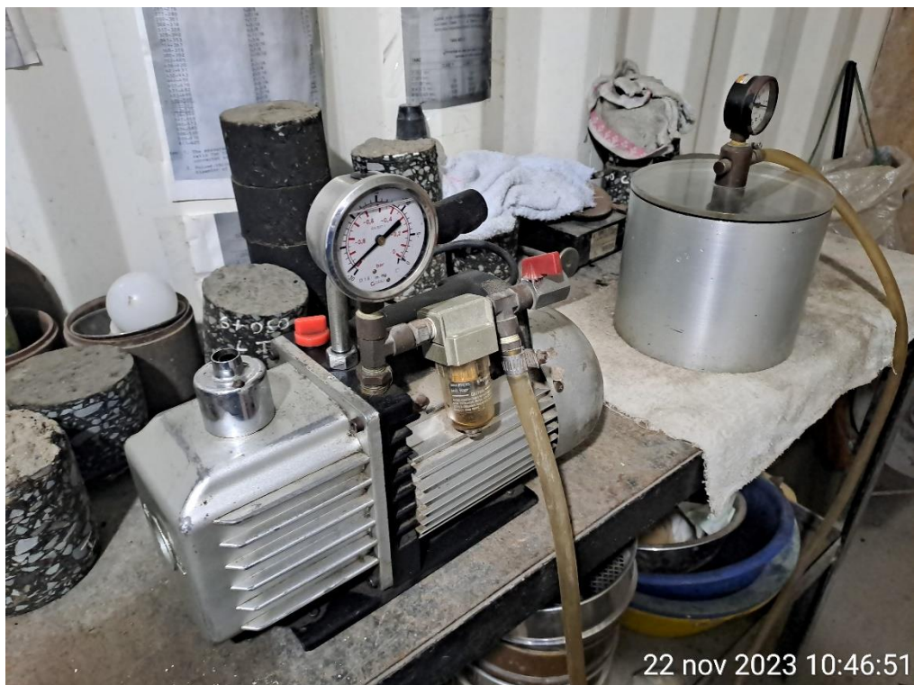
Ilustración 26 Mezcla asfáltica con PAR en caliente, Equipo Rice
