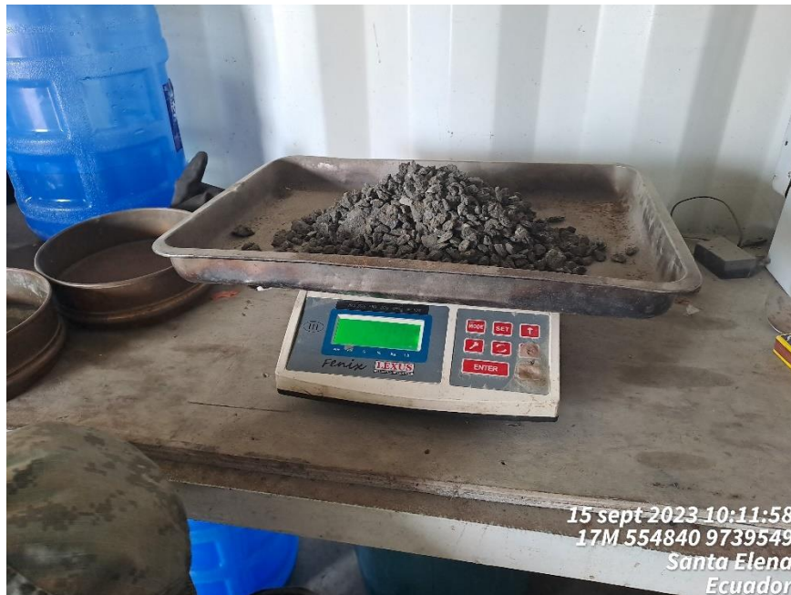
Ilustración 14 Ensayos de material PAR, pesaje para ensayo de gravedad
