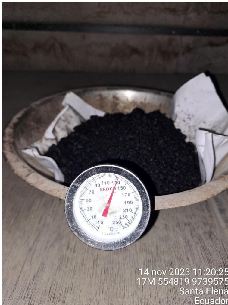
Ilustración 22 Mezcla asfáltica con PAR en caliente, toma de temperatura
