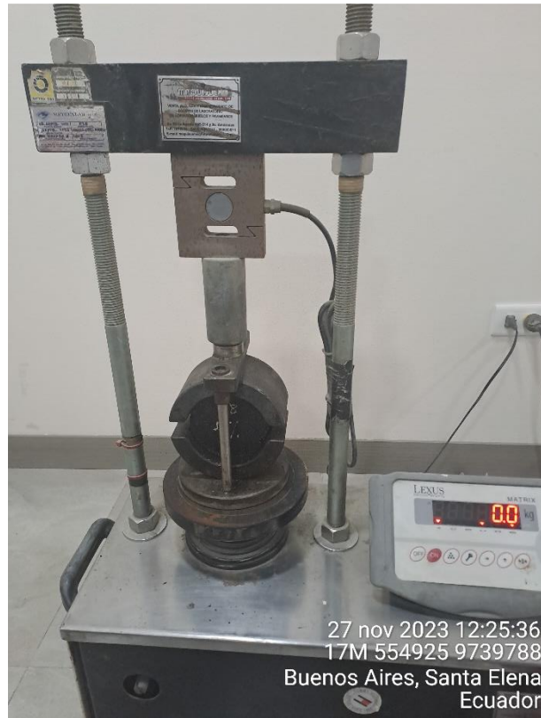
Ilustración 27 Briquetas de mezcla asfáltica con PAR, previo a prueba de estabilidad
