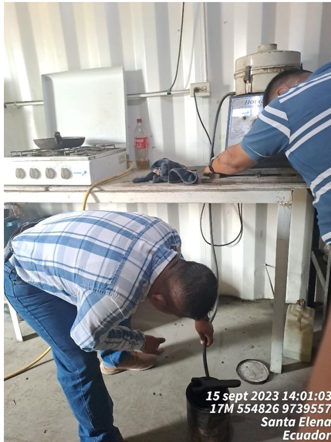
Ilustración 13 Ensayos de material PAR, extracción de asfalto.
