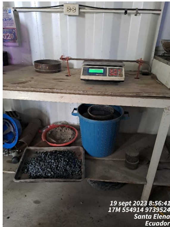
Ilustración 19 Ensayos de material virgen, Gravedad
