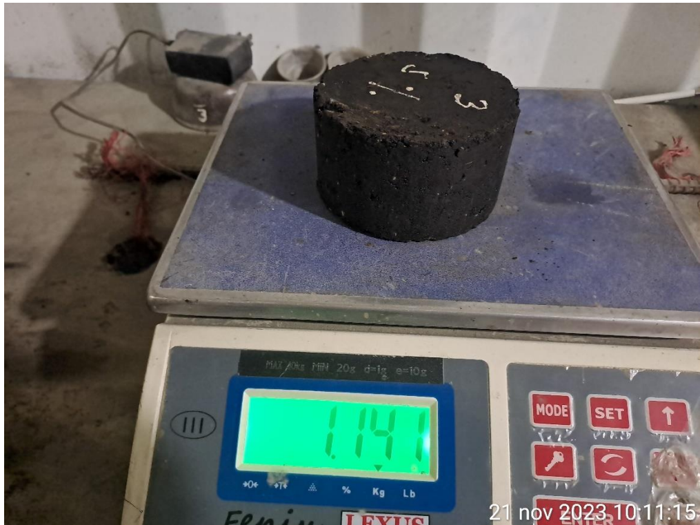
Ilustración 25 Pesaje de Briquetas de mezcla asfáltica con PAR
