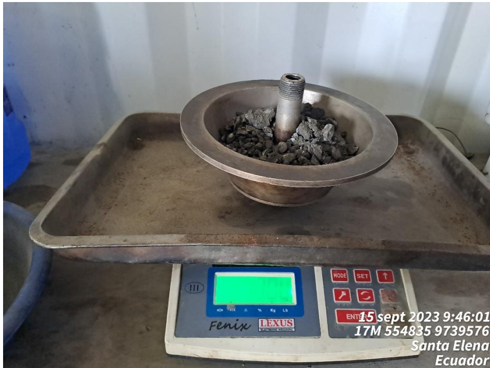
Ilustración 11 Ensayos de material PAR, pesaje de muestra para ensayo de extracción de asfalto Fuente: Elaboración propia
