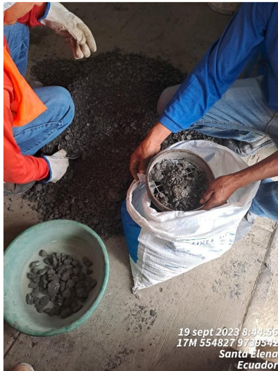
Ilustración 15 Ensayos de material PAR, graduación del material
