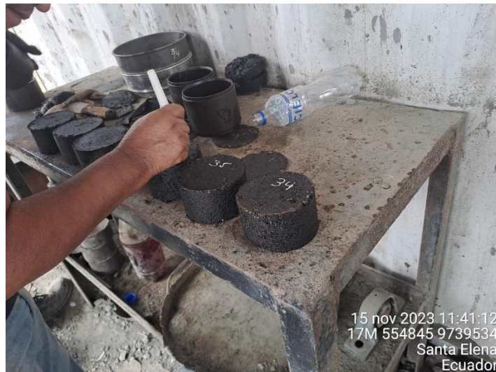
Ilustración 24 Identificación de briquetas de mezcla asfáltica con PAR
