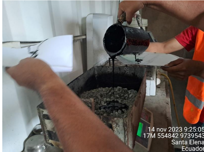
Ilustración 21 Inclusión de Asfalto AC-20 para Elaboración de mezcla asfáltica con 25% de PAR
