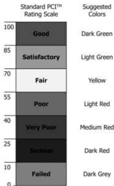
*Nota.* Valores de la condición del pavimento obtenidos de la norma ASTM-D-6433-11, 2011.
