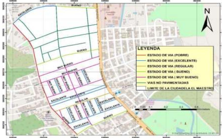
*Nota.* Mapa de clasificación del índice de condición del pavimento flexible, elaborado por Palma et al, 2023, Sistema de Gestión de Pavimentos basado en el empleo de un Sistema de Información Geográfica, Revista Ciencia y Construcción, volumen 4, 2023.
