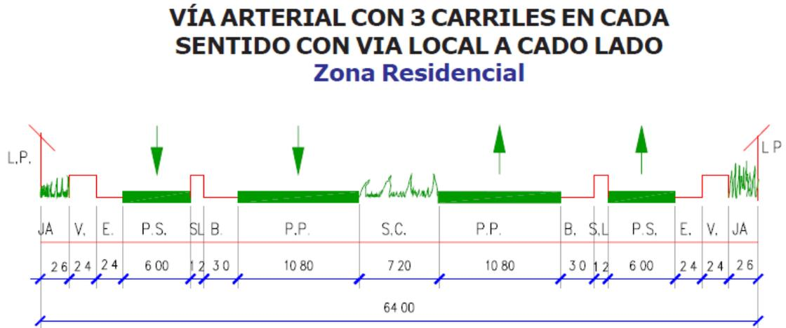
*Nota.* Sección típica de una Arteria principal con 3 carriles en cada sentido con vía local a cada lado, obtenido del Manual de Diseño Geométrico de vías Urbanas-2005.
