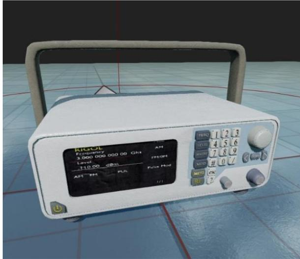
Figura 16: Modelo 3D de generador de señales
