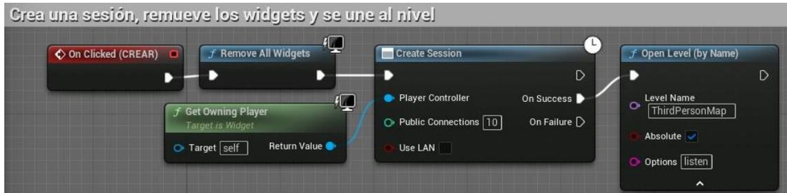
Figura 42: Función para crear una sesión y remover el widget
