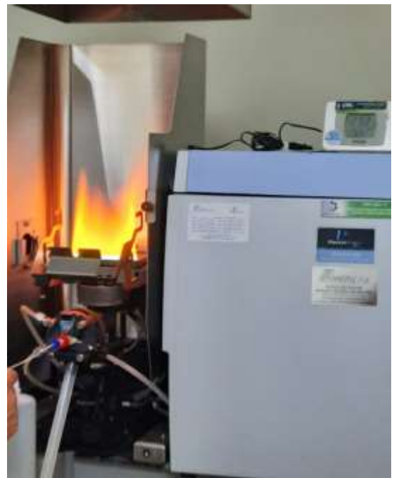
Espectrómetro de absorción atómica de radiación lampara de catodo hueco de llama de la marca Perkin Elmer AA Analyst 400, la longitud de onda que se utilizó fue de 228,8nm.
