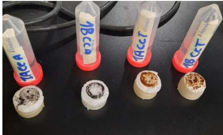
Estudio de desorción con la muestra oxidada con tiempo y el adsorbente con H_2SO_4
