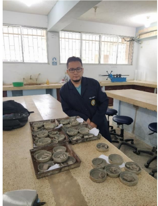
Ilustración 47. Muestras de los ensayos realizados para determinar los límites de Atterberg
