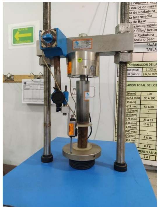
Ilustración 48. Ensayo para determinar esfuerzos de compresión
