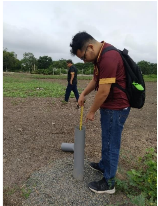
Ilustración 52. Medición del nivel freático del suelo mediante orificio al aire libre
