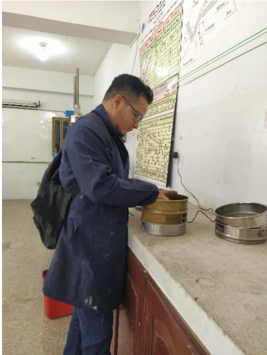
Ilustración 45. Tamizado de las muestras para realización de granulometría por lavado
