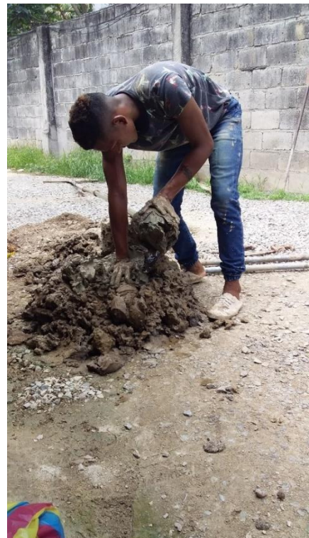
Ilustración 44. Muestras del suelo obtenido mediante ensayo SPT
