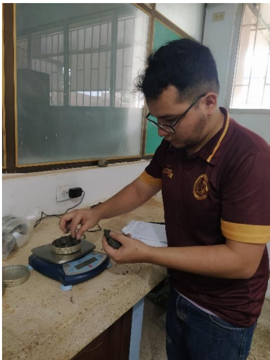
Ilustración 50. Preparación de muestra de suelo para determinar su humedad natural
