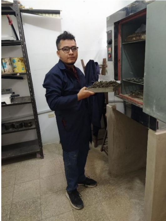
Ilustración 49. Colocación de muestras del suelo en el horno
