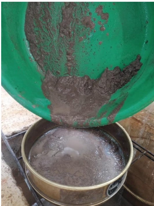
Ilustración 46. Lavado del material para determinar su clasificación por medio de norma USCS
