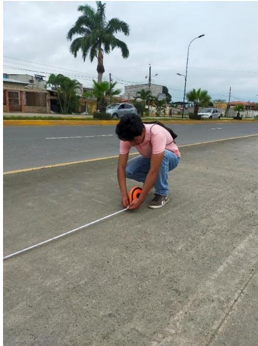
Fotografía realizando la medición del ancho de la vía.
