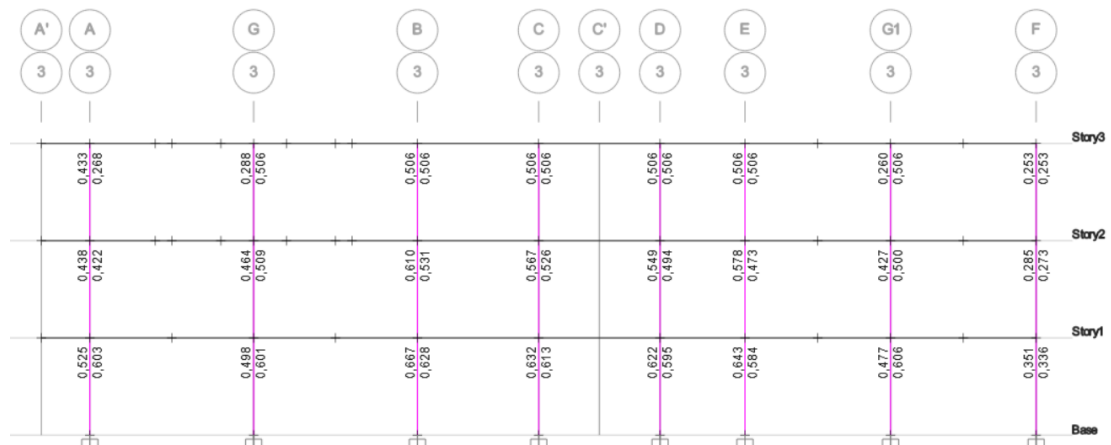
Ilustración 35 Relación de la capacidad de la columna fuerte/viga débil eje 3.
