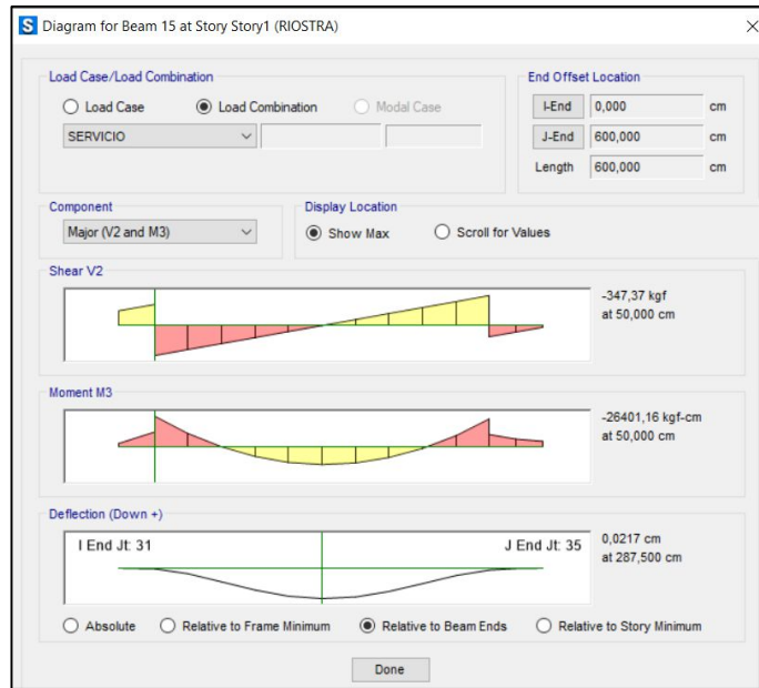
Ilustración 54: Diagrama de Cortante y Momento
