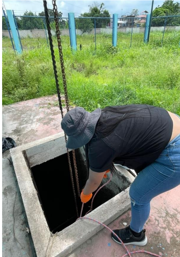
Figura 4. Toma de muestra en el afluente de la Planta de Tratamiento
