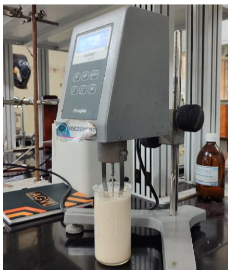
Anexo 8 Ensayo de viscosidad en la crema
