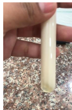
Figura 4 Separación en dos fases después de centrifugación en una réplica del lote #3
