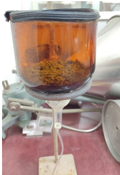
Anexo 3 Obtención del extracto hidroalcohólico por medio de percolación
