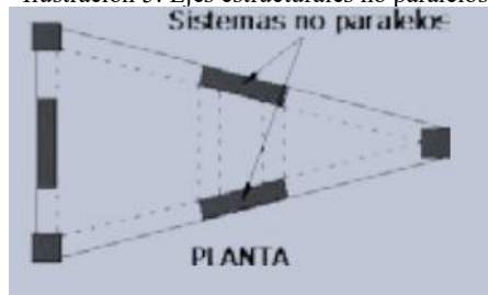
Ilustración 5: Ejes estructurales no paralelos
