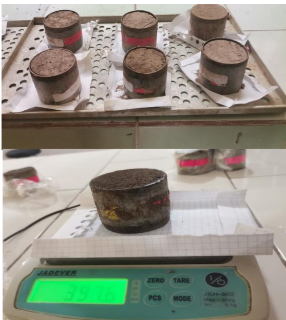
Figura 7: Pesaje de cilindros en húmedo Fuente: El Autor
