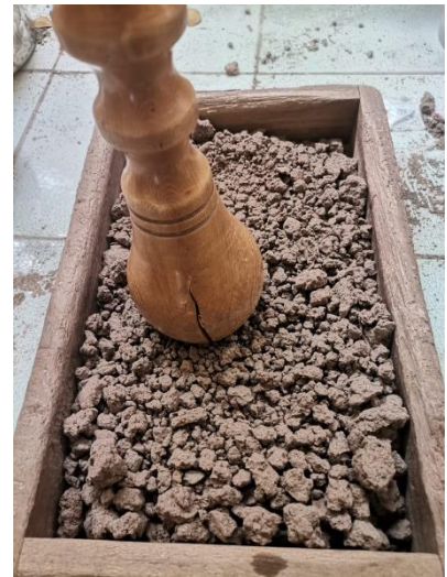
Figura 8: Pulverización de los terrones secos Fuente: El Autor
