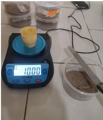
Figura 12: Relación 10 gr de suelo tamizado y 20 ml de agua destilada Fuente: El Autor
