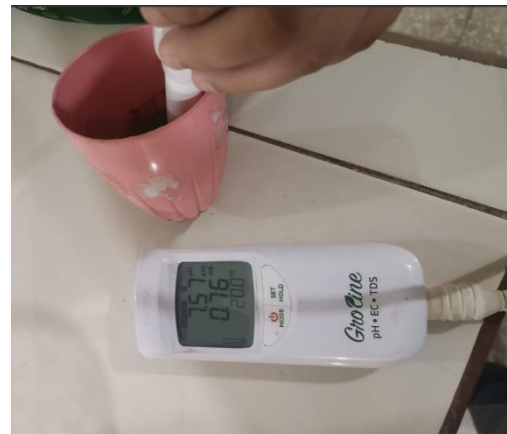
Figura 11: Medidas de pH de suelo tamizado Fuente: El Autor
