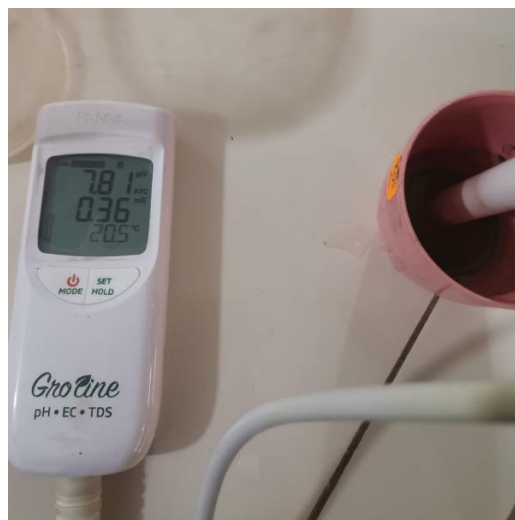
Figura 13: Medidas de Conductividad Eléctrica del suelo tamizado Fuente: El Autor
