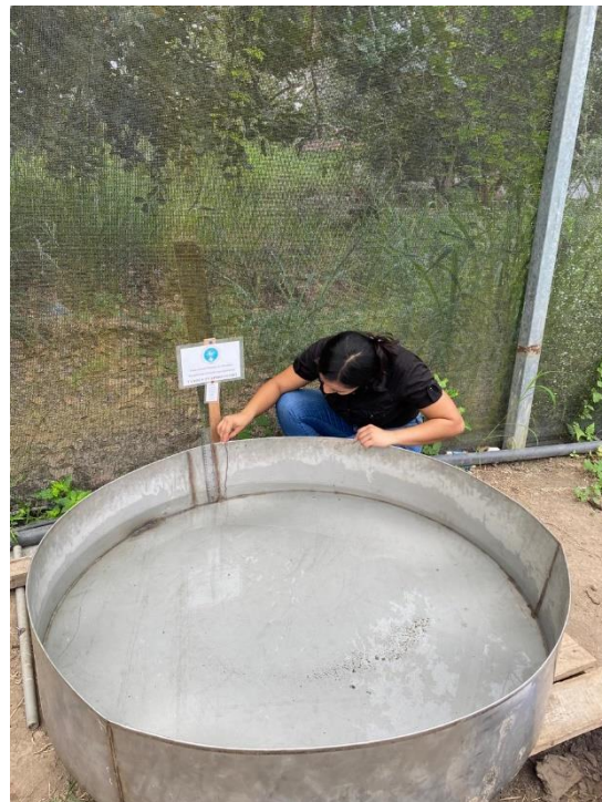
Figura 20 Medición del tanque evaporímetro
