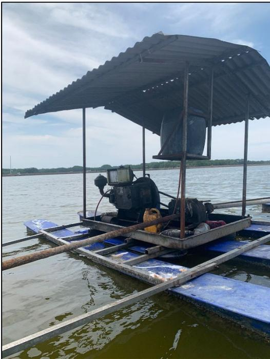
*Anexo D: Aireador rotativo utilizado en las mediciones de oxígeno*
