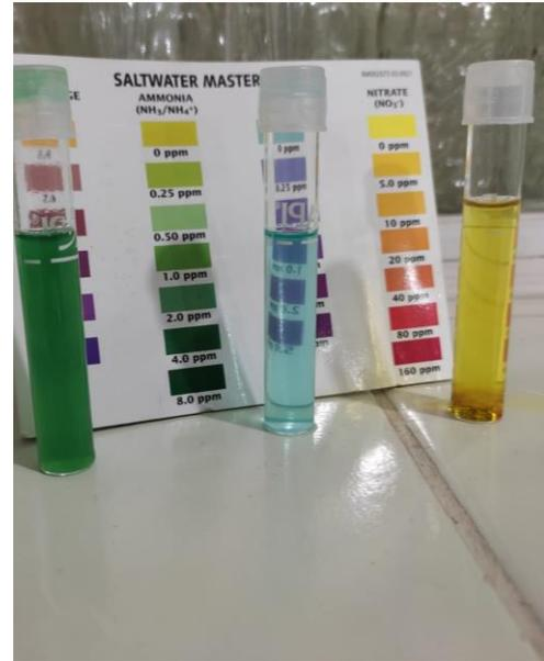
Ilustración 26 Medición de compuestos nitrogenados
