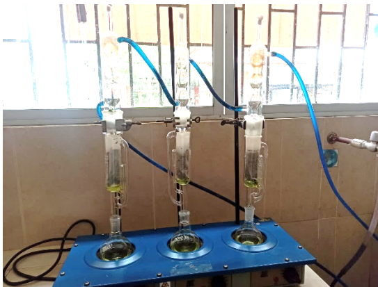
Anexo 3: Proceso de extracción en Soxhlet
