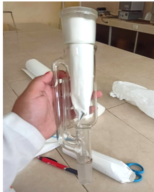
Anexo 3: Proceso de extracción en Soxhlet
