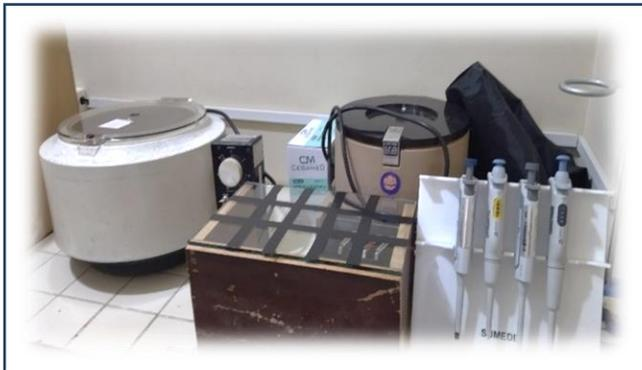
7.1.3.- Centrifugadora, micropipetas, caja con placa
