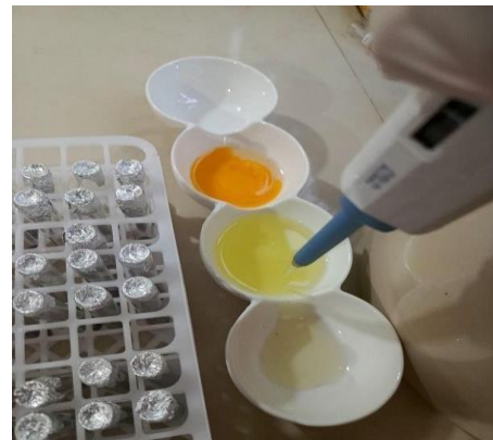
8.1.4. Recolección de 100 \mu\text{L} de la muestra de clara con ayuda de la micro pipeta
