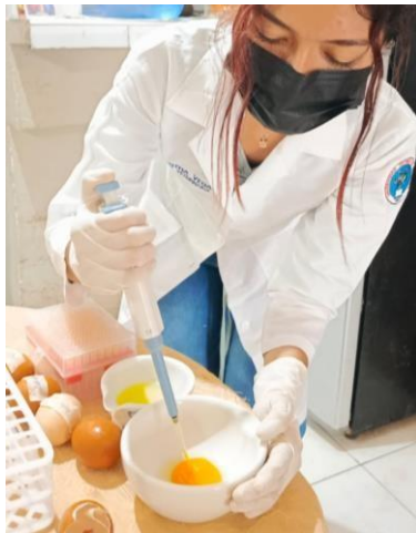
8.2.3. Recolección de 100 \mu L de la muestra de yema con ayuda de la micro pipeta
