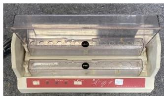
Cuenta con un botón de encendido y de regulación de temperatura, además de los pozos donde se colocan los tubos de ensayo y una cubierta de plástico que se puede utilizar de manera cerrada o abierta según sea la necesidad. (AMSCO, s.f.)
