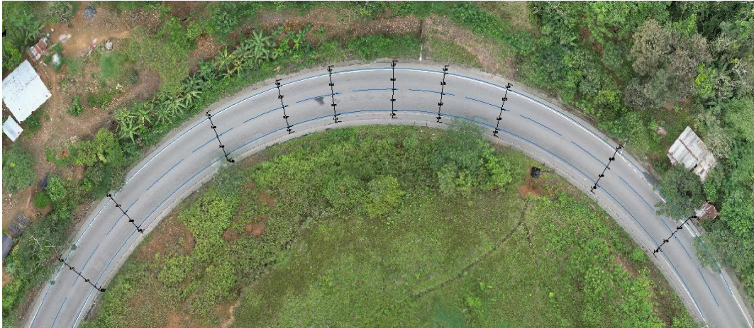
Ilustración 7 Ancho de carril y berma medido en AutoCAD Civil 3D
