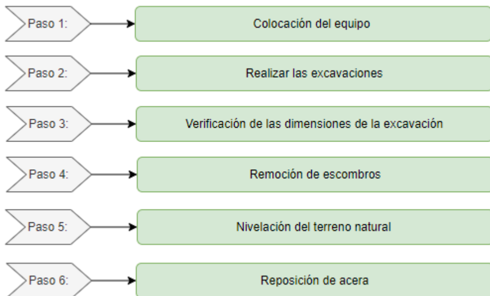
Ilustración 36: Proceso constructivo del rubro de excavación.
