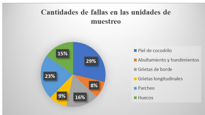
Ilustración 3.- Fallas en la zona de estudio
