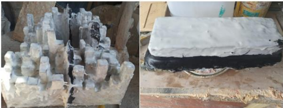
Figura 20. Moldes de silicona para la elaboración de la parte superior de la obra que se realizara en resina poliéster.
