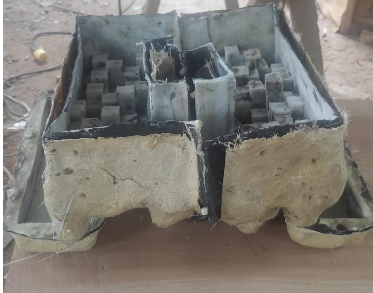
Figura 21. Contra molde hecho en resina y fibra.
