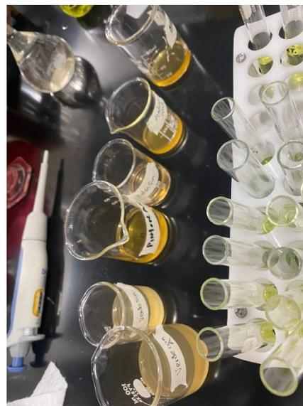
**Anexo 11:** Colocación de la disolución en las cubetas para ser llevados al espectrofotómetro
