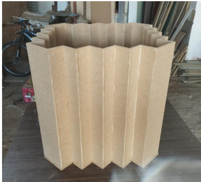
Imagen 23. Unión de 4 lados iguales formados por 32 regletas de 60x7 y 4 regletas de 60x14. 2023
