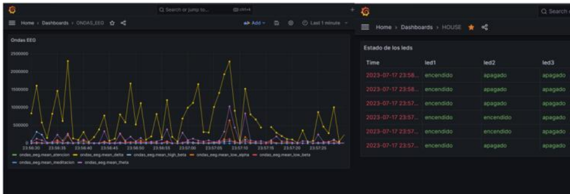
Ilustración 27. Dashboard en Grafana de los datos de onda y estado de los LEDs
