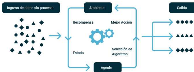
Ilustración 7. Esquema de un modelo de aprendizaje por refuerzo
