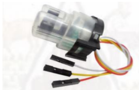
Figura 11. Sensor de turbidez de agua
