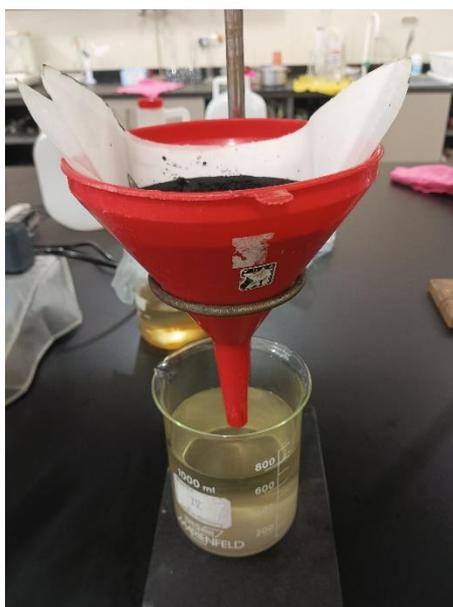
**Anexo 7. Solución previa al secado para la obtención de carbonato de potasio**
