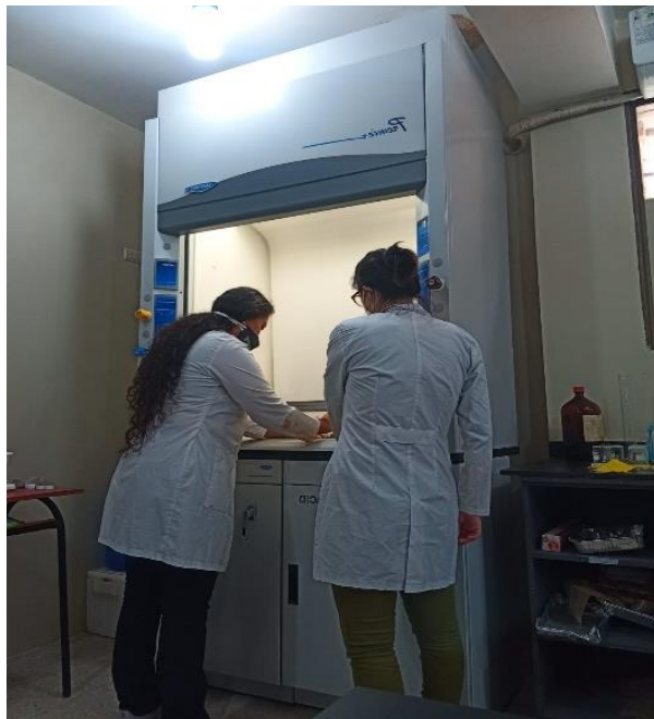
Ilustración 6. Extracción de gases nitrosos en la campana extractora
