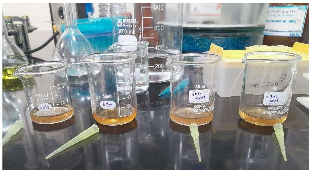
**Anexo 13:** Colocación de la disolución en los tubos de ensayo para ser llevados al espectrofotómetro
