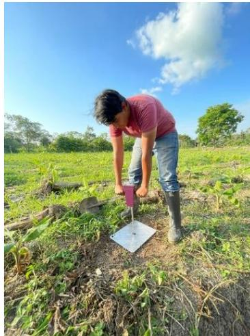
**Figura 9.** *Medición de la resistencia mecánica a la penetración*
