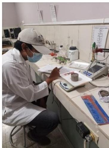
**Figura 7.** *Pesado de muestras no alteradas por método del cilindro*
