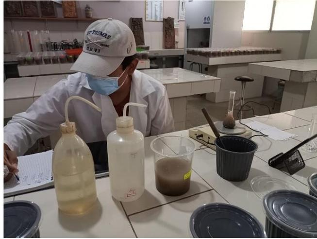
**Figura 6.** *Determinación de densidad real en laboratorio*
