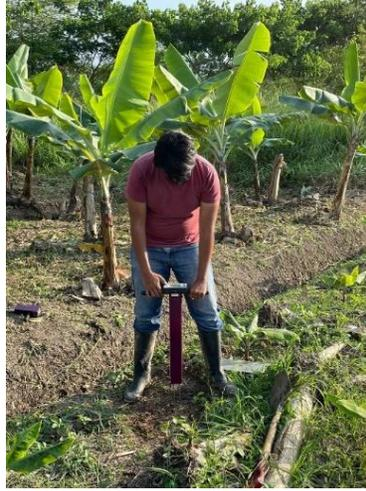
**Figura 8.** *Lectura de contenido de humedad con sonda TDR 350 Field Scout*
