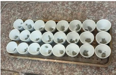
Figura 23. Proceso de ignición de crisol con muestra a 360 °C por 2 horas en mufla NABERTHERM.
