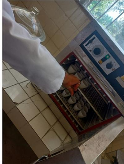
Figura 22. Criosoles con muestras salidas de estufa.
