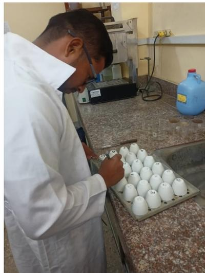
Figura 20. Pesaje de cada crisol seco y con muestra de suelo.
