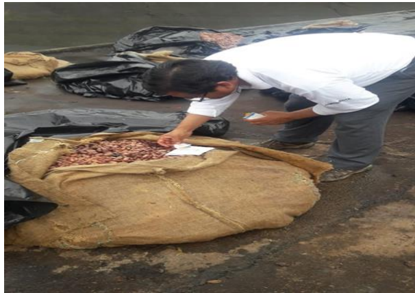
Foto 7. Toma de datos pH. Usando cintas indicadoras de pH.
