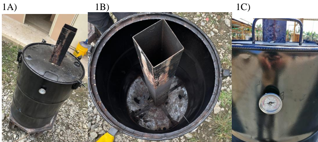
Figura 1. Construcción de reactor pirolítico: A) vista frontal del reactor; B) interior del reactor; C) Termómetro acoplado al reactor
