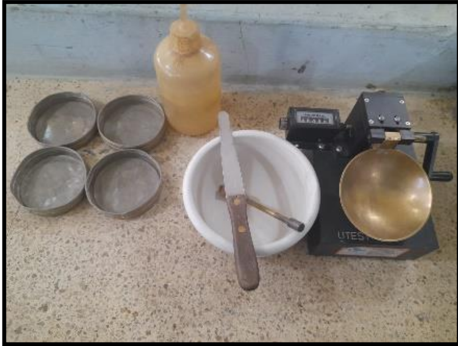
Anexo 7 Equipo utilizado para el ensayo del límite líquido
