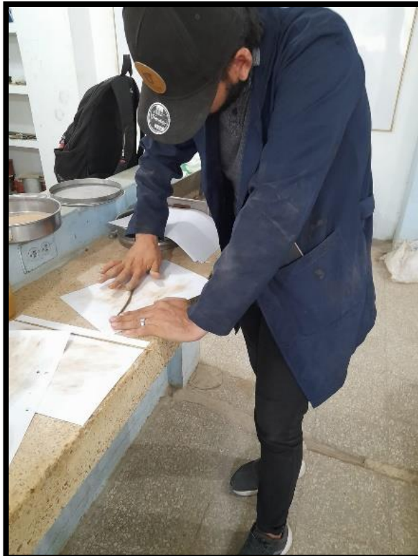
Anexo 9 Cuarteo para la extracción de la muestra en el ensayo del límite líquido
