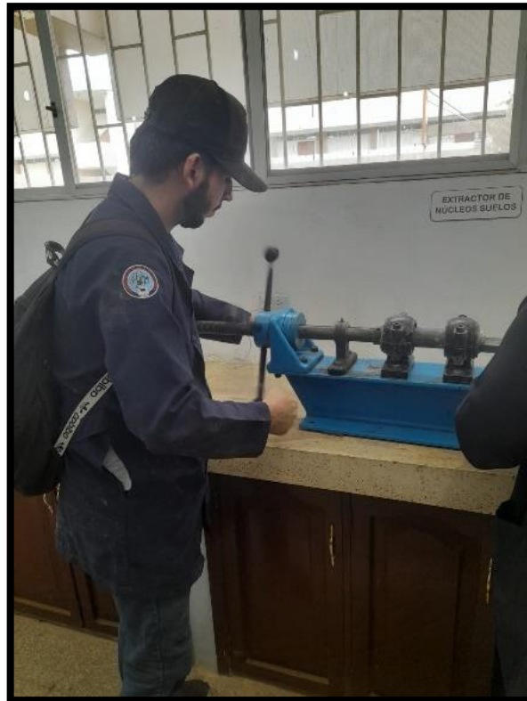
Anexo 11 Extracción de la muestra de suelo del tubo Shelby
