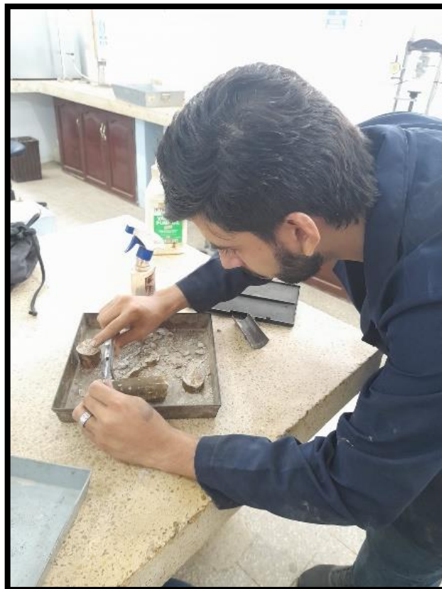
Anexo 13 Tallado del cilindro para el ensayo de compresión simple
