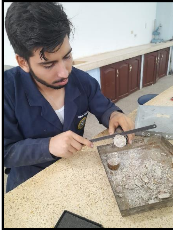
Anexo 13 Tallado del cilindro para el ensayo de compresión simple
