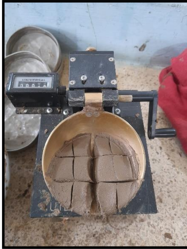
Anexo 9 Cuarteo para la extracción de la muestra en el ensayo del límite líquido
