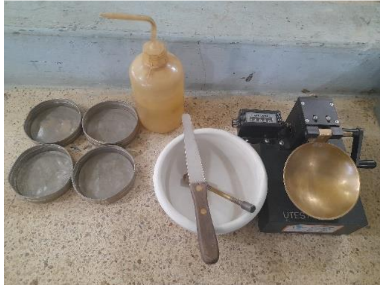
Figura 6 Equipo para determinar el límite líquido. Fuente: Autor
