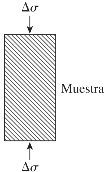
Figura 7 Esquema gráfico de la muestra de suelo. Fuente: Fundamentos de ingeniería en cimentaciones, Braja M. Das
