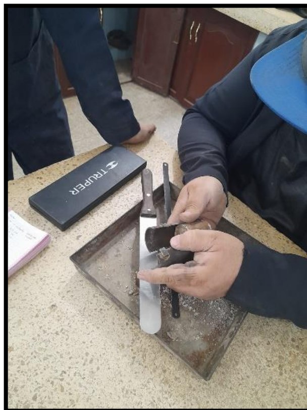
Anexo 11 Extracción de la muestra de suelo del tubo Shelby
